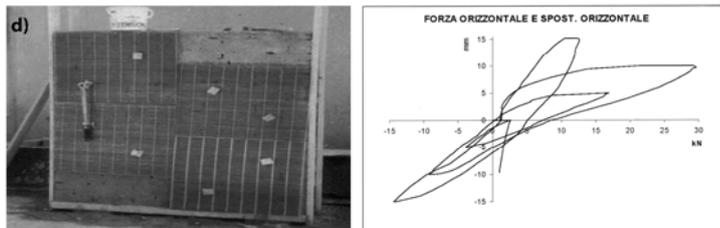
**Efficacia del serraggio ripetuto dopo rottura ciclica dei muretti consolidati senza iniezioni**
