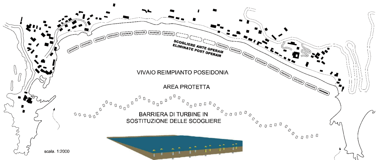
Figura 10a Barriera di turbine a protezione di una baia meno soggetta alle correnti litoranee.
